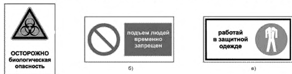
а) — текст расположен ниже знака безопасности; б) — текст расположен справа от знака безопасности, в) — текст расположен слева от знака безопасности
